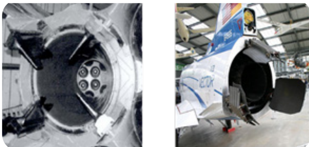
شکل ۶- استفاده از پره و پارو جهت انحراف جریان سیال
